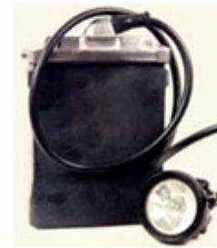
Lampe électrique à batterie. Cette lampe a 2 ampoules : une pour une utilisation normale et une de secours.
